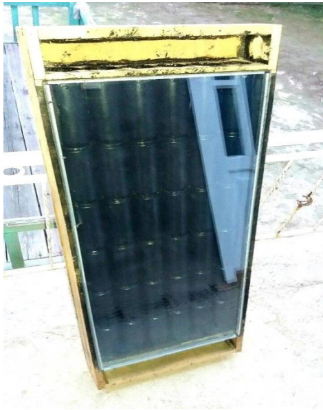
1-rasm. Quyosh havo kollektorining qora jism yuzasini to'liqsimon qilib bajarilganligi.
