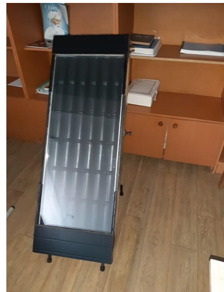
1-rasm. Quyosh havo kollektorining qora jism yuzasini to'liqsimon qilib bajarilganligi.
