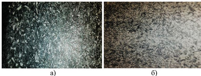
Рис.2. Микроструктура мелкоугольчатого мартенсита: а-нормальная закаленная структура X300; б-после закалки и отпуска структура мелкоугольчатого мартенсита с включениями глобулярных мелких карбидов. X500
