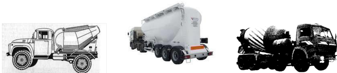
2-расм. Узоқ масофага ташишда бетон ва бетонқоришма ташувчи махсус автомобиллар.
