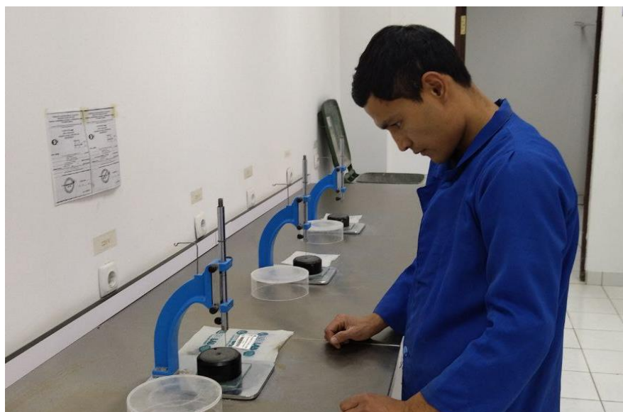
1-rasm. Sement namunalarining siqilishga bo'lgan mustahkamligini o'rganish.
